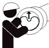
Colocación del empaque
